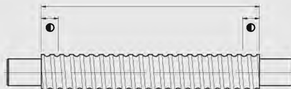
Рис 4.8 Термообработка винта ШВП производства HIWIN
