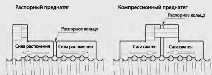
Рис 4.17 Преднатяг установленный с помощью распорного кольца
